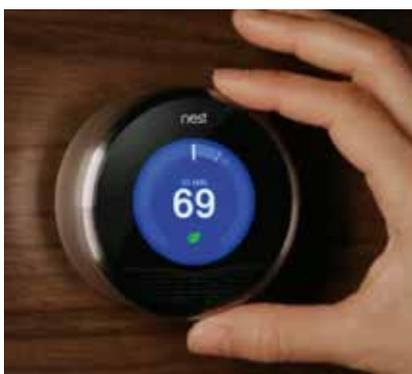
Las Vegas) e disponibile solo negli USA, *Nest* è un termostato intelligente progettato per far risparmiare: impara dai nostri comportamenti, dalle nostre preferenze e dalle nostre abitudini, le memorizza e crea un programma di riscaldamento e di raffreddamento personalizzato, mantenendo il massimo comfort quando si è a casa, per risparmiare energia quando si è lontani. E ovviamente, essendo un termostato "smart", può essere controllato a distanza con un iPhone o un telefono Android.
