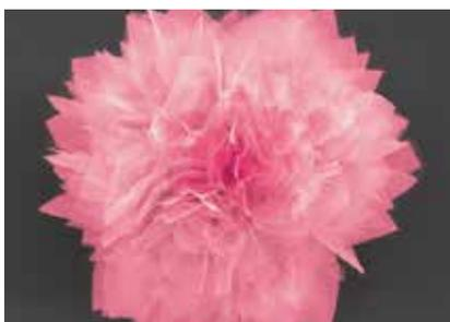
zione questo materiale semiconduttore viene ridotto in strati di appena 20-30 nanometri e assume una forma "floreale" che permette di ottenere superfici molto ampie in spazi ridottissimi. Il solfuro di germanio è inoltre adatto per la trasformazione dell'energia solare in elettricità e dunque molto interessante anche per l'utilizzo nelle celle solari.
