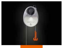
lampada alimentata solo dalla forza di gravità. Attaccando a una speciale cinghia un sacco contenente un peso qualunque (sassi, sabbia, ecc.), la lampada attiva una dinamo che in soli 3 secondi genera energia sufficiente per 25 minuti di luce. Il dispositivo può essere utilizzato anche per alimentare altre piccole luci, una radio o per ricaricare le batterie.
