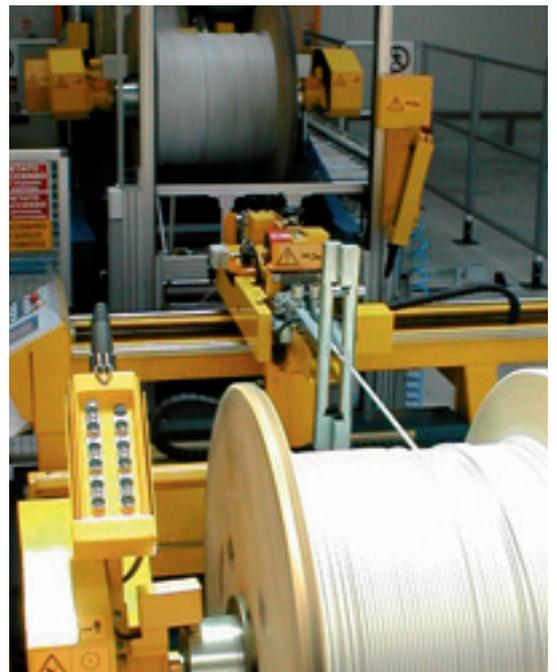
gira intorno a un trasloelevatore (macchina in grado di depositare o prelevare unità di carico in e da un sistema a scaffalatura). Il traslatore ha un binario centrale e, tramite un quadro di comando posizionato a terra, è in grado di prelevare le bobine dagli scaffali laterali.
