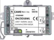
A717148    | Modulo Uscite È dotato di due uscite a relè con contatto NA, libere da potenziale, per il controllo di due carichi elettrici singoli, come luci, o di un carico elettrico doppio, come un motore per tapparelle, e di due ingressi digitali a 230 V CA per dispositivi di controllo, come pulsanti o interruttori. Il contenitore può essere installato in un quadro elettrico su guida DIN o incassato nel fondo della scatola. | 1    |             |
