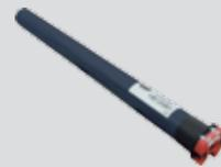
Operatore filare irreversibile per tapparelle preassemblato con accessori base per l'installazione. Peso max tapparella 88 kg. coppia massima 50 Nm e potenza assorbita pari a 285 W. Velocità rotazione albero 12 rpm.
