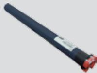
Operatore filare irreversibile per tapparelle preassemblato con accessori base per l'installazione. Peso max tapparella 35 kg. coppia massima 20 Nm e potenza assorbita pari a 180 W. Velocità rotazione albero 16 rpm.
