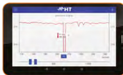
Esempio di visualizzazione Registrazione effettuata (Evidenti interruzioni di tensione)
