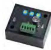
Ricevitore attivo di segnale video AHD/TVI/CVI su cavo UTP Cat5e/Cat6, connettore tipo BNC per uscita segnale video, terminali a vite estraibili per collegamento cavo UTP e alimentazione, distanza raggiungibile 600 m (AHD/CVI)/500 m (TVI) @ 1080p con trasmettitore attivo art. AHUTP61TC, contenitore plastico, colore nero, alimentatore incluso.
