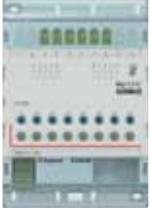
F430R8 | F430/4    | <p>Attuatore con 4 relè indipendenti - per carichi singoli, doppi o misti: 4 A resistivi, 1 A valvole motorizzate, pompe e fan-coil - interblocco logico dei relè tramite configurazione - 2 moduli DIN</p>                                                                                                                                                                                                                                 |
