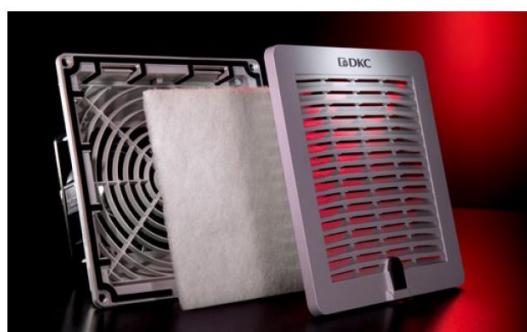
Sistema composto da gruppo ventilazione e da una griglia con filtro. Montaggio del gruppo filtro ad incastro senza utilizzo di viti ed utensili.
