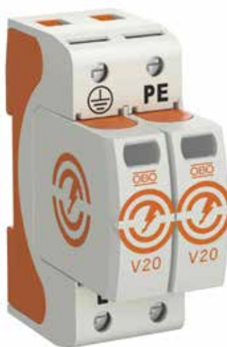
LIMITATORE TIPO 2 V20-2-280 Tensione nominale 280V Grado di protezione IP20
