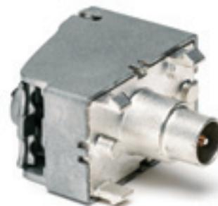
Prese a una uscita 5-2400 MHz con connessione a sportellino completamente schermate (Classe A). Le prese sono dotate di un innovativo sportellino per il fissaggio di cavi coassiali di diametro compreso tra 4 e 7 mm.
