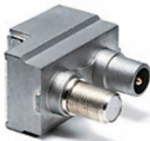
Le prese demiscelate permettono di separare su 2 connettori differenti un segnale combinato TV+SAT. Dotate di connettore a sportellino, consentono il fissaggio di cavi di diametro compreso tra 4 e 7 mm. È previsto il passaggio della corrente tra il connettore F (SAT) e il morsetto d'ingresso delle prese terminali, e tra il connettore F e il morsetto di ingresso/uscita delle prese passanti.
