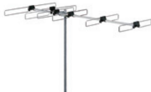
Antenna Yagi Banda III VHF a 6 elementi canalizzata. L'antenna è stata realizzata con dipolo chiuso e culla portante da 18x12x0,8 mm con elementi in tubo da 10x 08 mm. L'antenna viene fornita completamente preassemblata e dipolo con connettore F. L'antenna può essere installata in polarizzazione Orizzontale e Verticale. L'antenna viene fornita con connettore F e cappuccio di protezione connettore.
