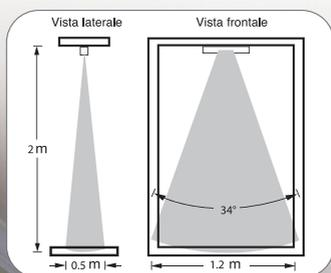
Questo tipo di rivelatore costituisce la migliore soluzione per la protezione di porte, finestre e di varchi in genere in quanto realizza un vero e proprio "effetto tenda" grazie alla presenza di una coppia di sensori ad infrarossi passivi.
